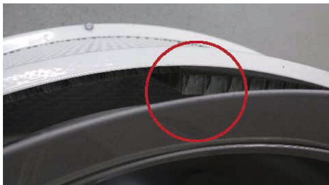
Abb. 14. Wabengleichrichter vor Ausrichtung
