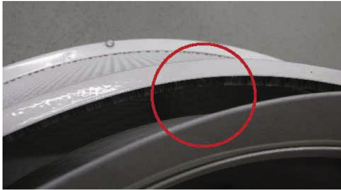
Abb. 15. Wabengleichrichter nach Ausrichtung
